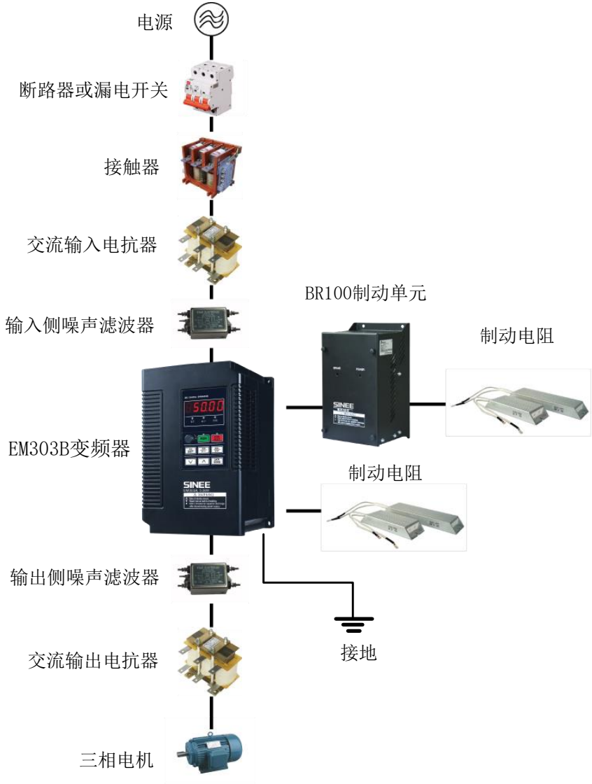
图 3-1 变频器与外围设备的连接图
